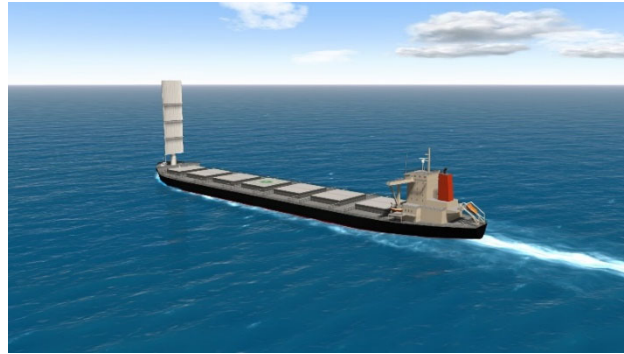
ビジュアルシミュレーター写真 上：硬翼帆を広げて航行中の様子 下：硬翼帆を低い位置に収納して着岸中の様子
